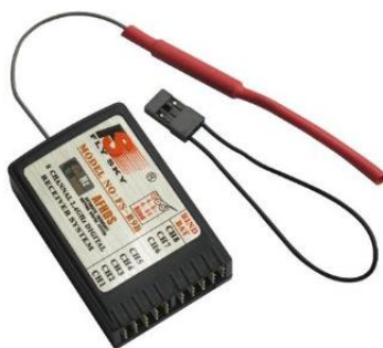
ภาพ 13 แสดงเครื่องรับสัญญาณวิทยุ Fly Sky FS-R8B
